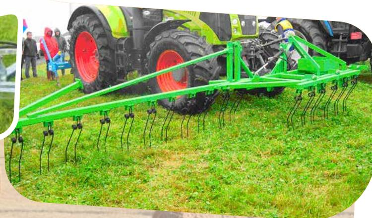
L'accrochage en trois points se fait sur un bâti qui déporte le système d'un mètre supplémentaire à l'avant du tracteur. Entièrement démontable, la barre d'effarouchement s'actionne grâce à un système de vérins hydrauliques. Le système est fourni avec des chaînes montées à l'aide de mail- lons rapides qui vont prévenir le petit gibier du passage de la machine. Des ressorts de stabilisation sont placés de chaque côtés du dispositif.
